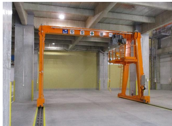
5 トン門型クレーン
